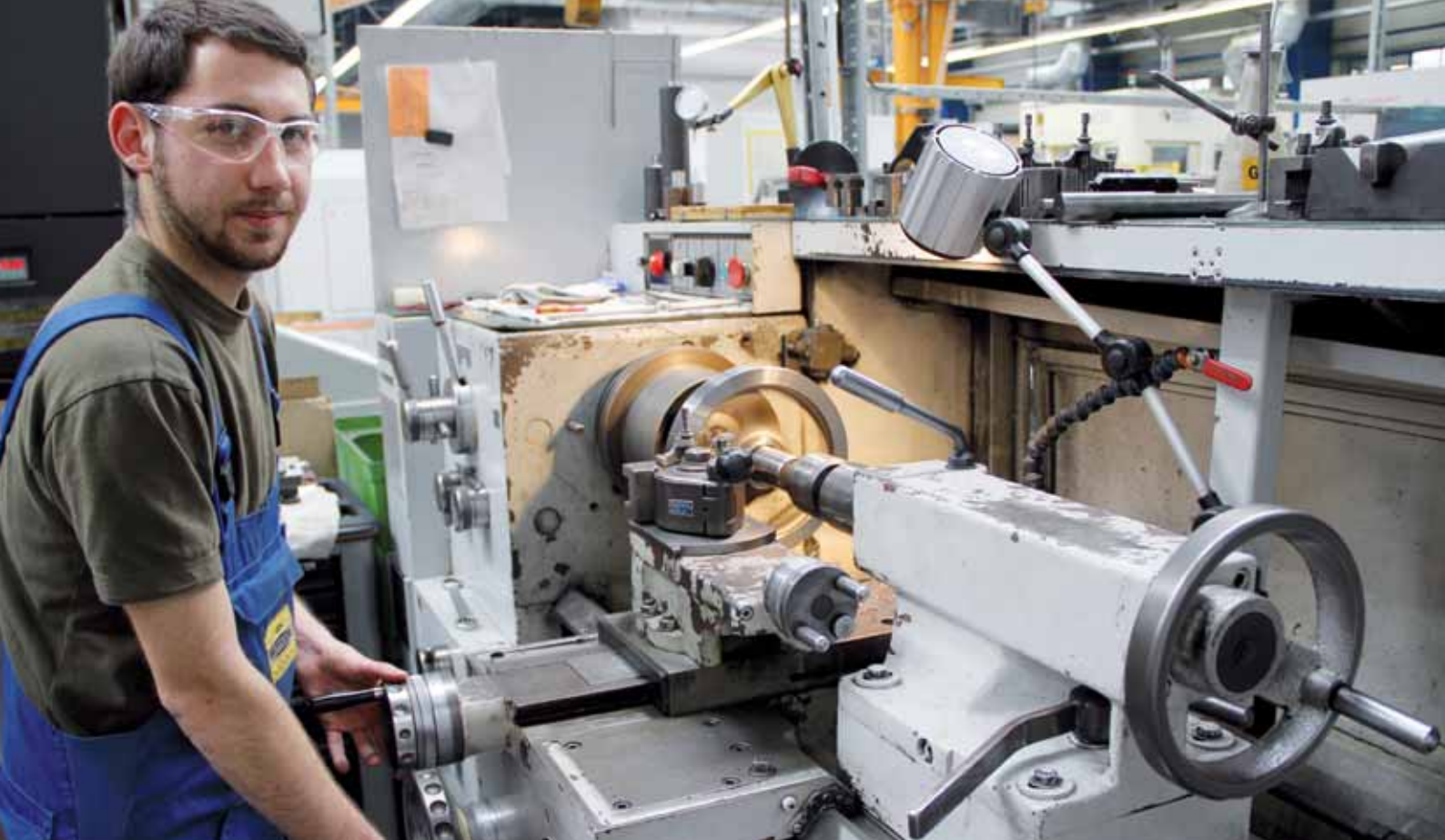
Alexander Bolgert lernt Zerspanungsmechaniker und ist durch einen Freund, der bereits bei GKN Walterscheid arbeitet, auf das Unternehmen aufmerksam geworden. Auf dem Bild ist er gerade mit dem Plandrehen von Zahnrädern beschäftigt.
