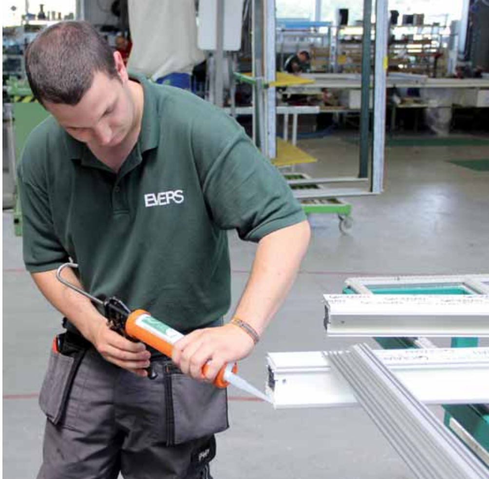
Richard Volkmer beim Schwellenbau für Türrahmen
